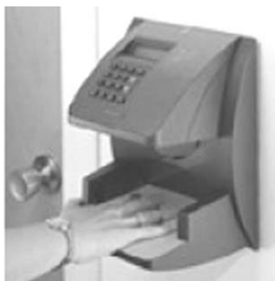
Рис. 3. Устройство идентификации по размерам кисти
